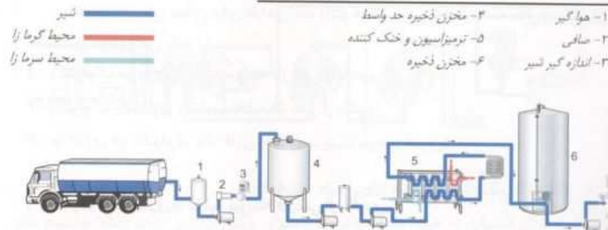
شکل ۲-۱۴ ترتیب و تدابیر دریافت برای شیر پنیر سازی
