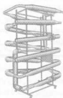
شکل ۳-۲۰ واحد پیوسته لخته سازی، پخت، آبیگیری برای تولید کازئین اسید لاکتیک، کازئین اسیدی، کازئین آنزیمی (پیلت)
