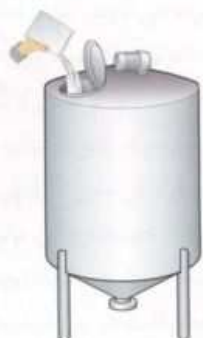
شکل ۲-۱۰ تولید توده کشت از کشت تجاری اولیه منجمد یا خشک شده در انجماد.
